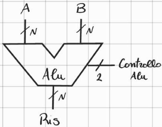
Un'Alu unisce all'interno di una singola unità una serie di operazioni logiche e matematiche. Prende in input  $A$  e  $B$  di  $N$  bit e Controllo Alu di 2 bit ed in base al valore di controllo Alu sceglie l'operazione da svolgere tra  $A$  e  $B$ .
