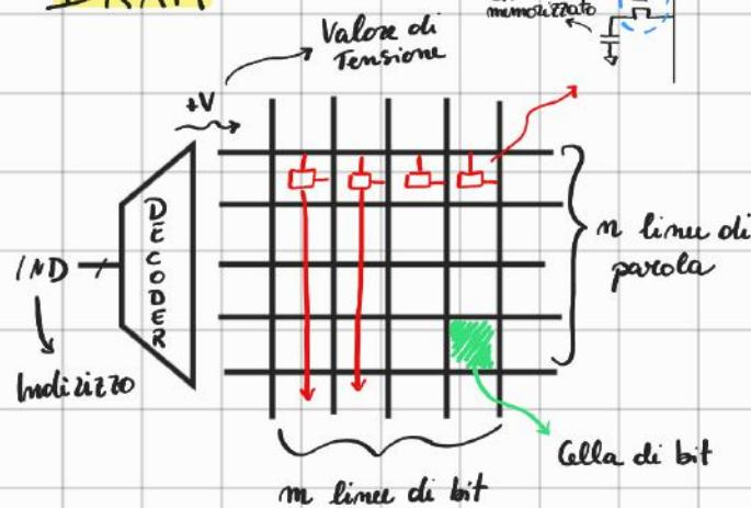
Memorizza un bit come presenza o assenza di carica in un condensatore. Il transistor si comporta come un interruttore che connette o disconnette il condensatore dalla linea di bit. Quando la linea di parola è attiva il transistor si accende e il valore del bit viene trasferito alla o dalla linea di bit (lettura - scrittura). Il bit vale 1 se il condensatore è caricato a  $V_{DD}$ , altrimenti, se viene scaricato, il bit vale 0.
