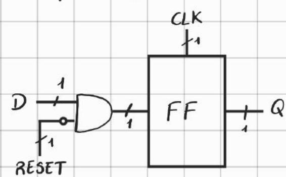
Un Flip-Flop RESET aggiunge un ingresso RESET. Se  $RESET = F$  si comporta come un normale Flip-Flop D, se  $RESET = T$  viene ignorata  $D$  e viene settata l'uscita  $Q$  a 0.
