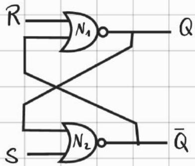
Il Latch-SR ha due ingressi, S e R e due uscite Q e  $\bar{Q}$ . S e R attivano (set) e disattivano (reset) l'uscita Q.
