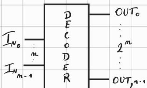
Il decodice ha  $n$  ingressi e  $2^m$  uscite e attiva una delle sue uscite a seconda delle combinazioni dei valori in ingresso. Le uscite sono dette "One Hot".
