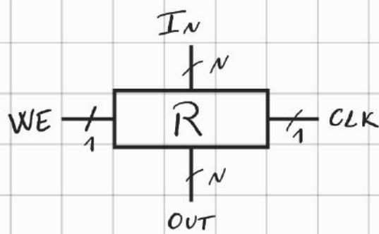
Un registro prende in input un clock e un WE, se entrambi valgono 1 il registro produce in uscita lo stesso valore ottenuto in input se non rimane stabile.
