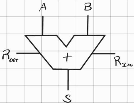
Il Full-adder ha tre ingressi  $A$ ,  $B$  e  $R_{in}$  e due uscite  $S$  e  $R_{out}$ . Se la somma tra  $A$  e  $B$ ,  $R_{out}$  è il riporto in uscita e  $R_{in}$  è il riporto in ingresso.
