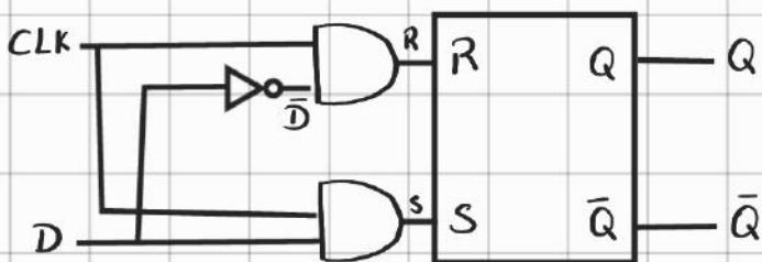
Il Latch-D ha due ingressi: un ingresso dati D che controlla il prossimo stato e un ingresso clock CLK che controlla il momento del cambio di stato.
