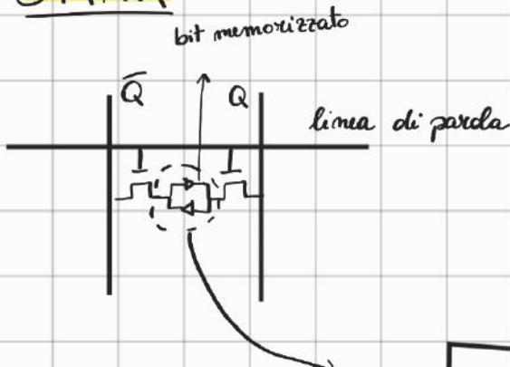
I bit immagazzinati non hanno bisogno di essere ricaricati. Il bit viene immagazzinato grazie a due negatori a croce, ogni cella possiede due uscite  $Q$  e  $\bar{Q}$  e quando la linea di parola viene attivata entrambi i transistori si accendono e i bit di dato vengono trasferiti da o verso le linee di bit (lettura-scrittura).
