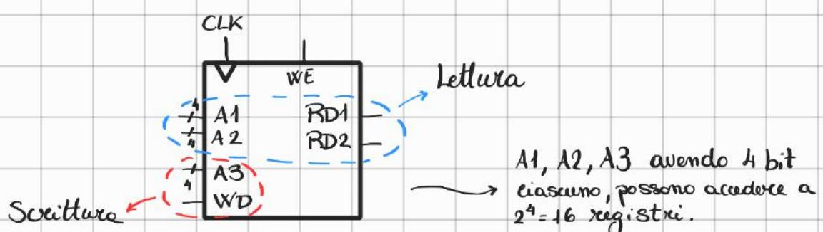
I sistemi digitali usano spesso un certo numero di registri per immagazzinare variabili temporanee. Questo gruppo di registri prende il nome di "banco di registri", solitamente costruito come una piccola componente SRAM multi-porta poiché più compatta rispetto ad una matrice di flip-flop.
