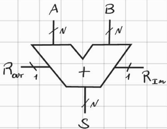
Un carry propagate adder ha due ingressi a N bit A e B e R<sub>in</sub> a 1 bit. Produce un risultato a N bit S e R<sub>out</sub> a 1 bit. Il reporto di un bit si propaga nel bit successivo.
