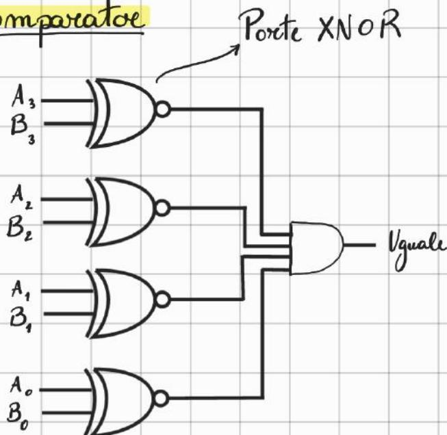
Un comparatore riceve due numeri binari a N bit A e B e determina se sono uguali. Esistono due modi:
