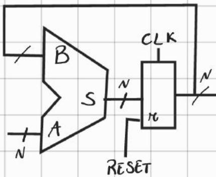
Un contatore a  $N$  bit prende in input un CLK e un RESET e produce un output  $Q$  a  $N$  bit. Il RESET inizializza l'output a 0, successivamente il contatore genera i  $2^N$  possibili valori di uscita in ordine crescente aumentando di 1 ad ogni fronte di salita del clock. Ad ogni ciclo del clock il contatore aggiunge 1 al valore immagazzinato nel registro.
