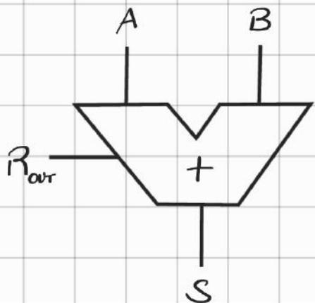
L'half-adder ha due ingressi  $A$  e  $B$  e due uscite  $S$  e  $R_{out}$ . Se la somma tra  $A$  e  $B$  è  $R_{out}$  è il riporto in uscita.
