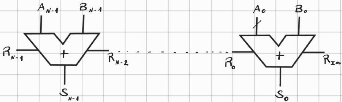
Per costruire un ripple carry adder a N bit bisogna collegare N full adder in cascata. R<sub>out</sub> di uno stato è R<sub>in</sub> di un altro.
