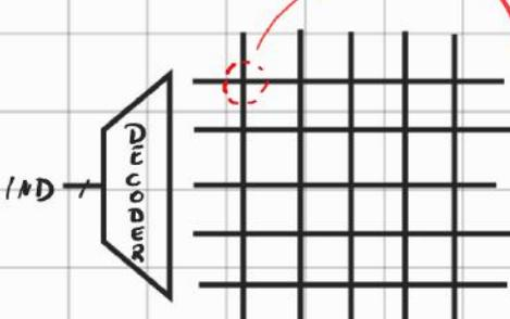
Memorizza un bit come presenza o assenza di un transistor. Se è presente, questo spinge la linea di bit ad un valore BASSO (0), se invece è assente la linea di bit resta ALTA (1).
