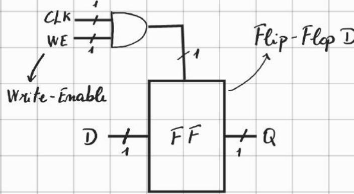
Un Flip-Flop EN aggiunge un altro ingresso WE per determinare se memorizzare o no il dato sul fronte del clock. Se  $WE = T$  si comporta come un normale Flip-Flop D, se  $WE = F$  ignora il clock e mantiene il proprio stato.
