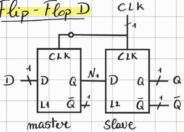
Un Flip-Flop D è costruito a partire da due Latch-D controllati da due segnali di clock complementari. Il primo latch L1 è detto master e L2 è detto slave,  $N_1$  è il modo che li unisce.
